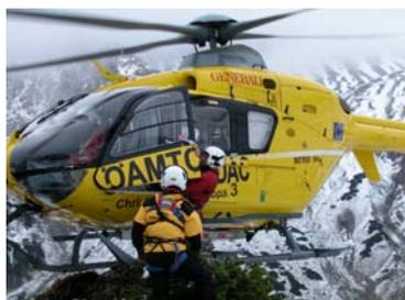
Gilbert Habringer, nous présente une vidéo sur la simulation d'une panne moteur lors de vol avec charge en classe D (HEC). Pendant le vol, une turbine a été mise au ralenti pour simuler la panne sur un moteur. Durant tous les tests, le pilote a pu déposer sa charge et effectuer un atterrissage normal tout en restant dans les limites moteur prescrites. A noter encore que ces tests ont été fait à des altitudes en dessous de 2500 mètres.
