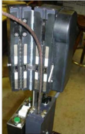
Zephyr International ([www.zephyrintl.com](http://www.zephyrintl.com)) a introduit sur le marché un système de contrôle pour les câbles de treuil (MagSens tm). Les câbles utilisés sont en acier et consistent en 19x7 torons. Un câble de 3/16" a une rupture statique entre 3300 et 3800 Lbs. Il y a deux producteurs de câbles, Loos and Company, Pomfret CT, qui équipe Breeze Eastern et Strand Core, Milton FL, qui équipe Goodrich.
