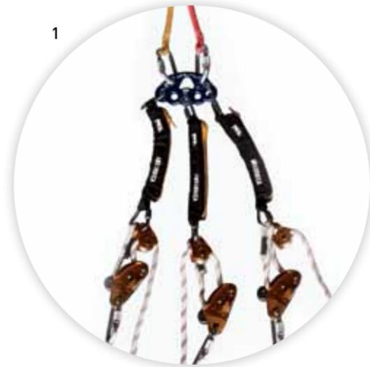
Die Seilenden werden separat mit einem OK-Karabiner (Verschluss nach unten) in den seitlichen Löchern der Verteilplatte (PAW Medium) eingehängt.
