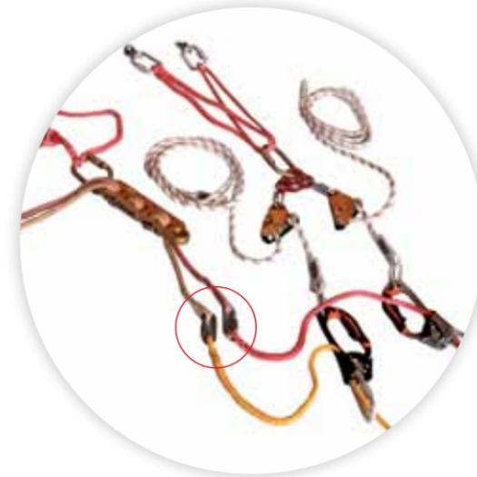
Abseilen mit Goldtail. Die Seilverlängerung mit den Schraubgliedern bis zirka 50 cm vor das Abseilgerät führen. Klemmen schließen. Last übertragen. Abseilgerät öffnen. Seile herausnehmen und nach den Schraubgliedern wieder in das Abseilgerät einlegen und verschließen.
