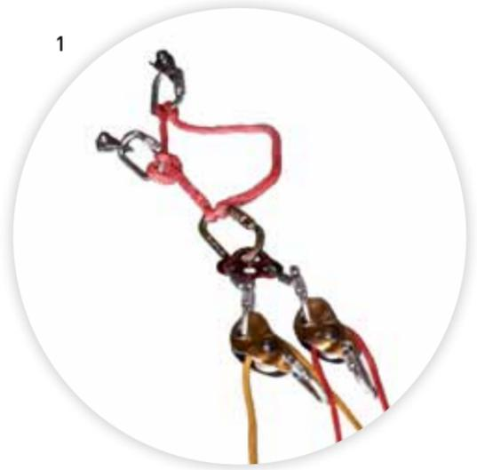
Vor dem Umbau auf Aufziehen werden die Pro Traxion geschlossen. Hierzu wird mit dem Finger der rote Verriegelungsknopf bei der Pro Traxion betätigt. Kontrolle, ob der Stift an der Rückseite im Gehäuse auch einrastet. Mit dieser Aktion wird die Last vom Abseilgerät auf die Pro Traxion übertragen.
