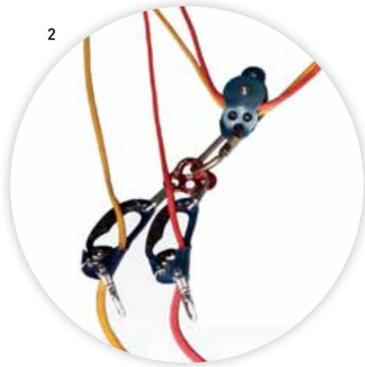
Nachdem die Pro Traxion geschlossen wurden, werden die Seile mit einer Doppelrolle nach unten umgelenkt. Die Doppelrolle wird mit einem Stahlkarabiner in einer Mini-PAW befestigt. In der Mini-PAW werden zwei Griffklemmen oder zwei Tibloc mit je einem OK-Karabiner montiert. Die Griffklemme wird zusätzlich mit einem OK-Karabiner gesichert. Von einer weiteren Verankerung werden die Seile mit einer weiteren Umlenkrolle nach unten geführt.
