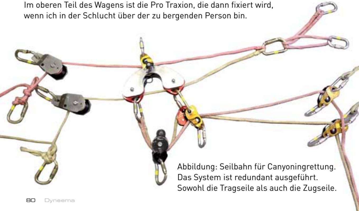
Abbildung: Seilbahn für Canyoningrettung. Das System ist redundant ausgeführt. Sowohl die Tragseile als auch die Zugseile.
