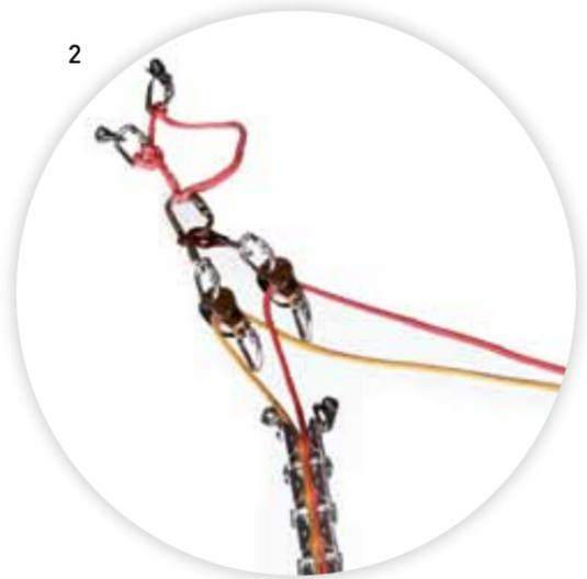
Verankerung mit Ausgleich oder Reihe. Stahlkarabiner – Verteilplatte Mini PAW. Schraubglieder OK-Karabiner – Pro Traxion. Sicherung der Pro Traxion mit OK-Karabiner. Zum Öffnen der Pro Traxion muss diese durch Ziehen nach unten zuerst entlastet werden.
