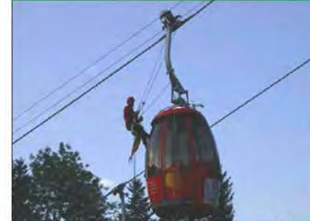
Mit der Seilumlenkung Stopbloc erfolgt der Abseilvorgang mühelos und selbstständig. Der Partner am Boden betreut in der Zwischenzeit die Seilbahnfahrgäste.
