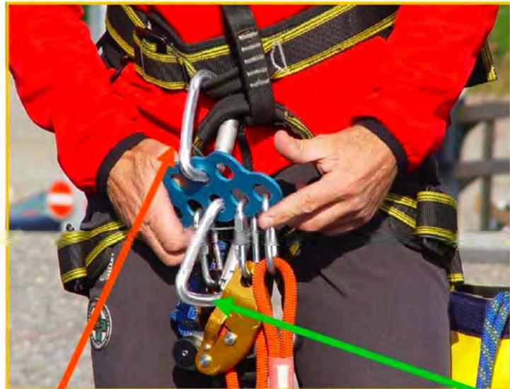
Karabiner mit rotem Pfeil wird parallel zum Hüftgurt in die Schlaufen gehängt.
