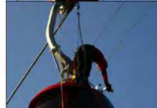
Am Dach der Gondel angelangt öffnet er mit dem Hebel die Verriegelung der Gondeltür.
