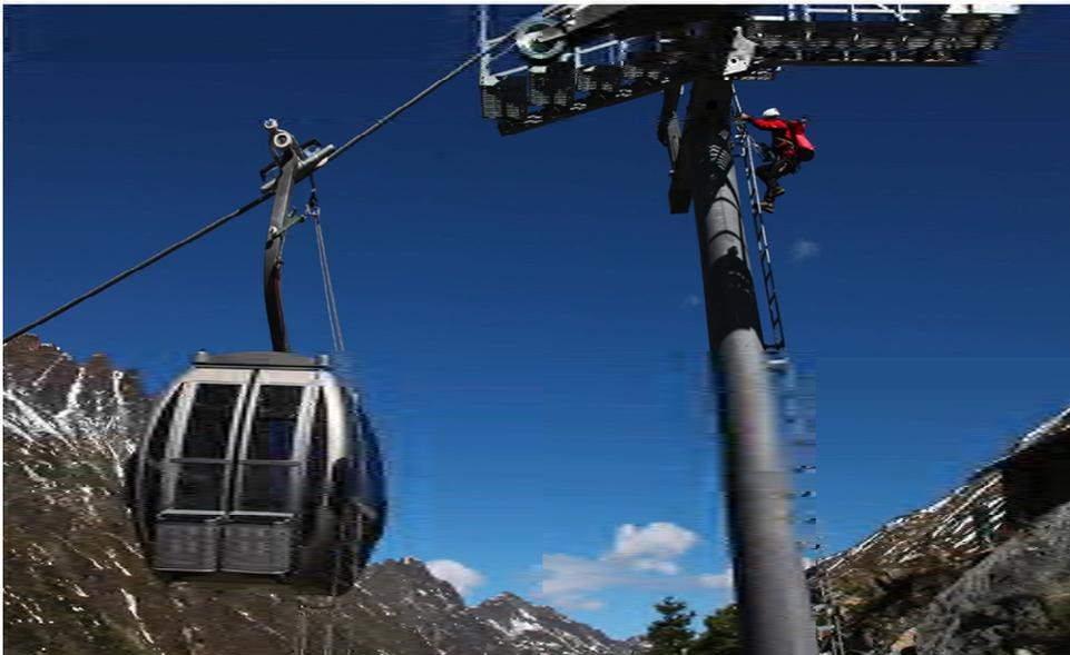
Nun wird der Retter zur Kabine aufgezogen. Mit zwei bis drei Helfern am Boden wird das Aufziehen erleichtert.
