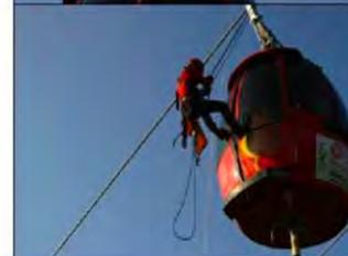
Nun fährt der Retter mit der langen Selbstseilrolle zum Boden der Gondel ab.
