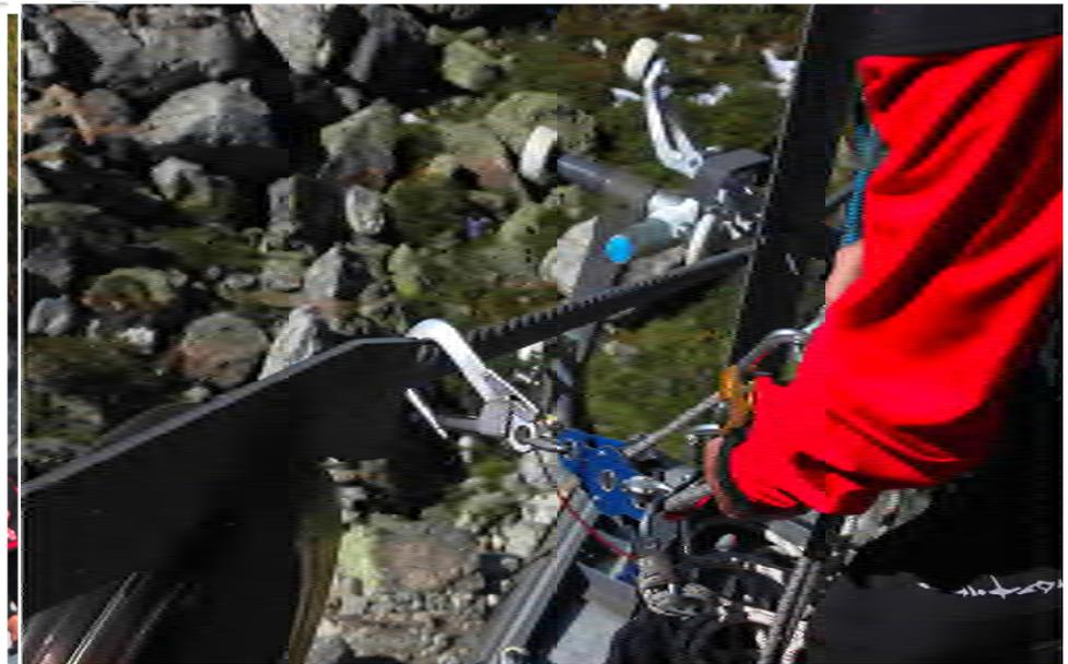
Der Karabiner der Aufziehvorrichtung wird in das Förderseil eingeklinkt. Das Seil wird aus dem Bergesack genommen. Bevor die Aufziehgarnitur über das Förderseil nach unten rutscht, ist der Klemmmechanismus der Pro Traxion zu öffnen. Andernfalls kann die Pro Traxion nicht nach unten gezogen werden.
