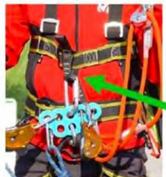
Karabiner mit grünem Pfeil wird in den Brustgurt eingehängt. Dadurch ist eine Redundanz des Retters gewährleistet.
