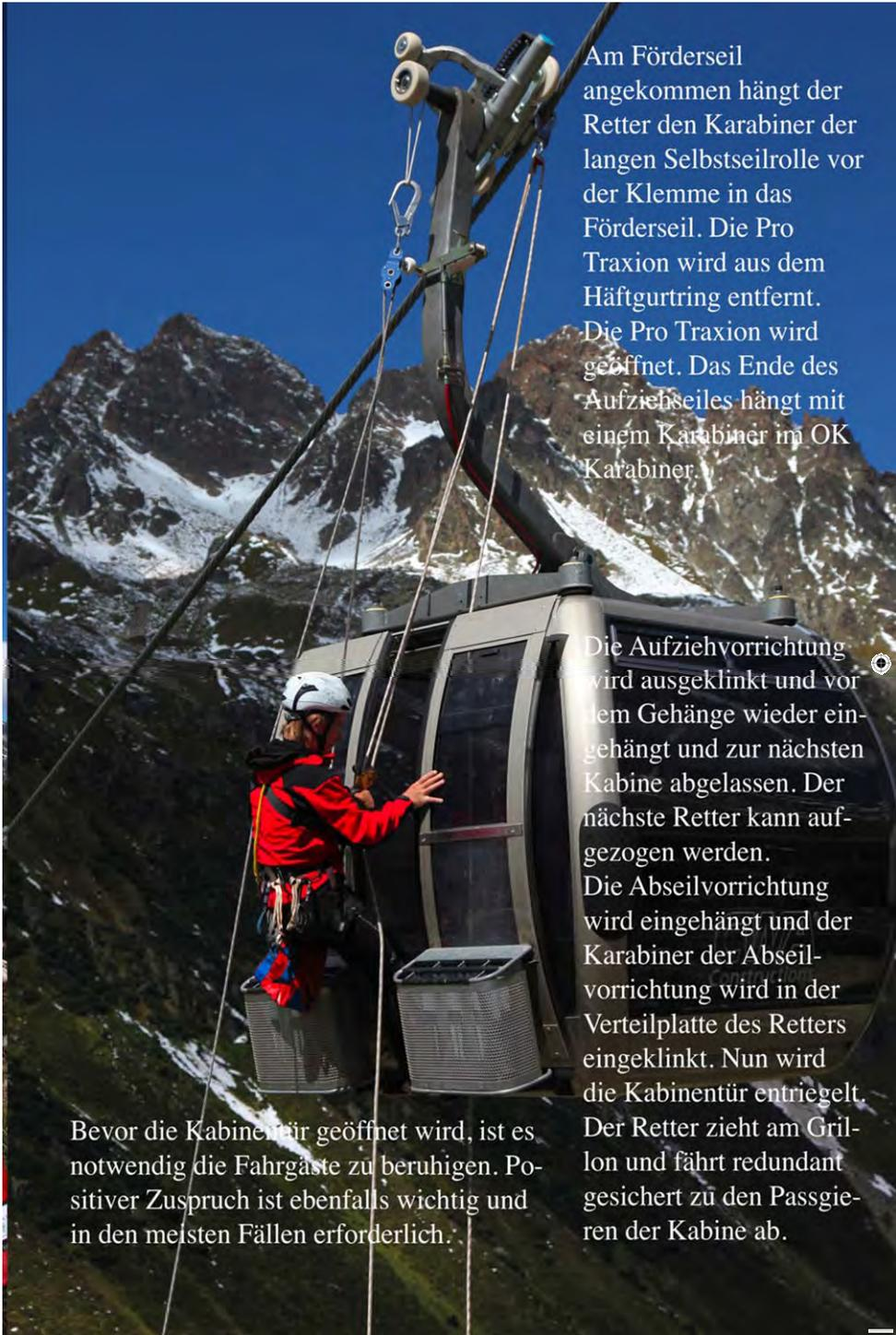
Am Förderseil angekommen hängt der Retter den Karabiner der langen Selbstseilrolle vor der Klemme in das Förderseil. Die Pro Traxion wird aus dem Häftgurring entfernt. Die Pro Traxion wird geöffnet. Das Ende des Aufziehseiles hängt mit einem Karabiner im OK Karabiner.
