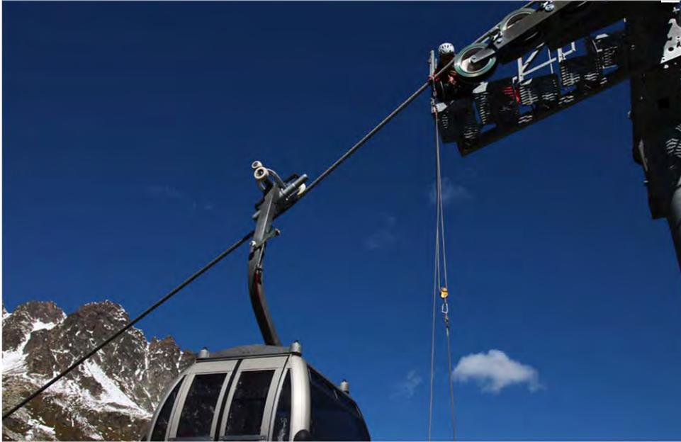
Bevor die Aufziehvorrichtung zur Kabine gezogen wird, ist es notwendig, dass vom Partner am Boden die Pro Traxion nach unten gezogen wird. Dadurch wird verhindert, dass sich die Pro Traxion selbständig beim Berühren der Kabine schließt. Der Retter steigt gesichert nach unten.
