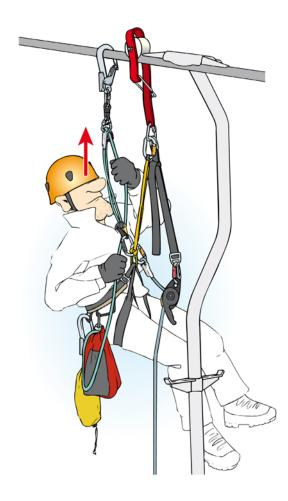
Der Retter kürzt den SSFZ zur Entlastung der gelben Schlinge und hängt diese dann im Einhängepunkt des Ablassgerätes ein. Die gelbe Schlinge dient zur redundanten Sicherung des Retters und des Ablassgerätes. Der Karabiner am Ende des Rückhalteseils kann aus der Anseilschlaufe des Gurtes ausgehängt werden.
